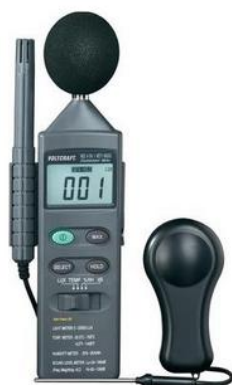
Obr. 1 Příklad přístroje na měření osvětlení: Luxmetr VC – 4in1
