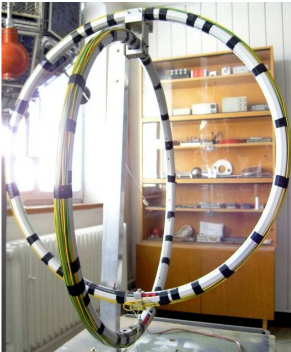
Dvojitá kruhová antena pro detekci magnetické složky hvizdů.
