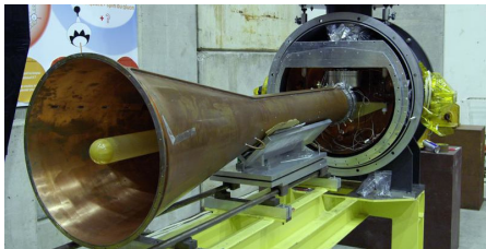
Vnitřek polarizovaného terče. [COMPASS]
