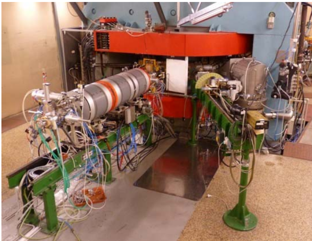
UJV Řež: cyklotron U-120M, p^+ , T = 5.4 - 38 MeV
