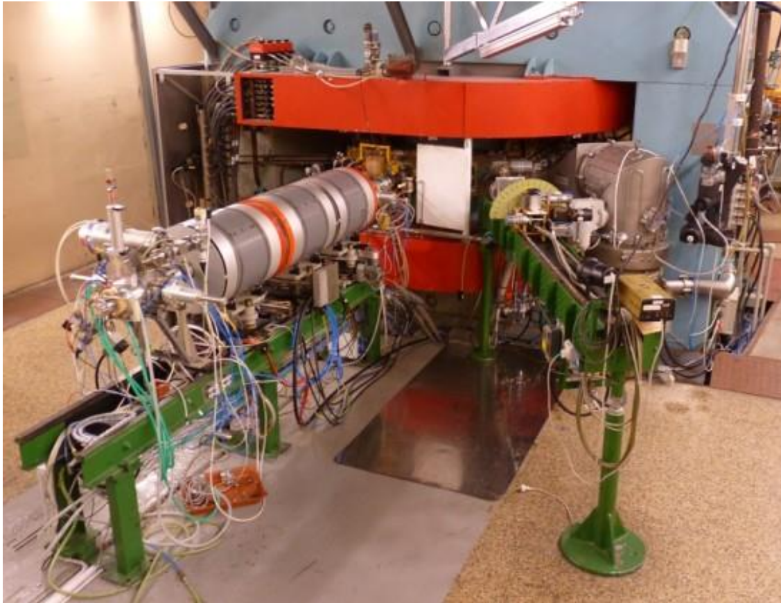
UJV Řež: cyklotron U-120M, p^+ 5.4 – 38 MeV
