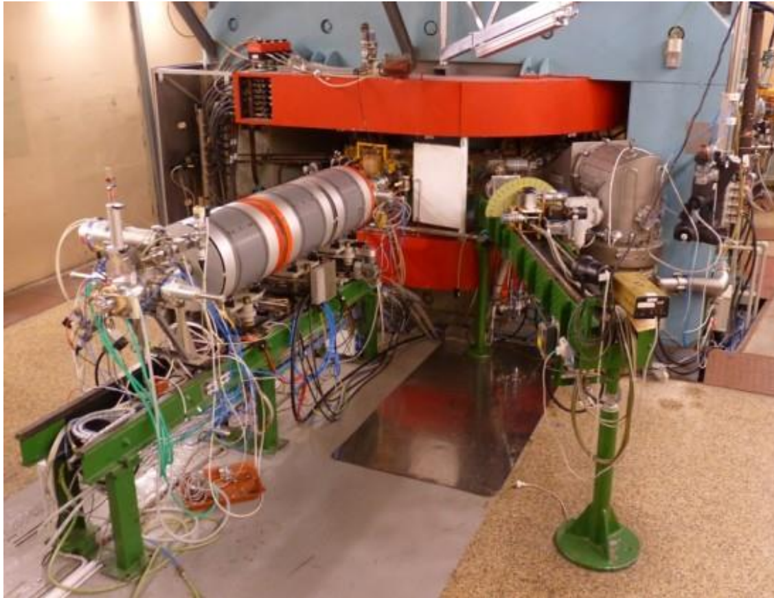
UJV Řež: cyklotron U-120M, p + 5.4–38 MeV
