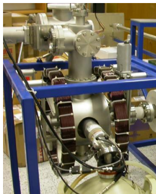
Obr. 5 (a) Detektorová část svazku pomalých pozitronů s laditelnou energií, (b) Závislost integrálního S-parametru na energii implantovaných pozitronů v Pd.
