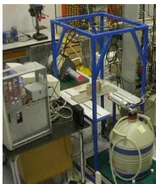
Obr. 4 (a) Digitální spektrometr pro koincidenční měření Dopplerovského rozšíření, (b) Dvourozměrné CDB spektrum měřené na Mg terčiku pomocí ^{68}\text{Ge} / ^{68}\text{Ga} generátoru pozitronů.
