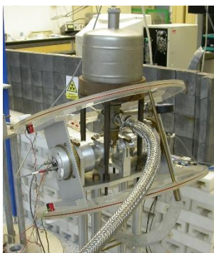
Obr. 3 (a) Digitální spektrometr dob života pozitronů s kryostatem pro měření při nízkých teplotách, (b) Spektrum dob života pozitronů pro monokrystal ZnO se střední dobou života pozitronů 181 ps.
