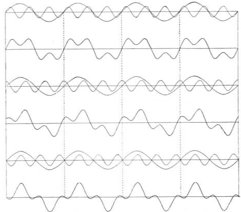
Obr. 8. Skládání vibrací stejnosměrných; prima a duodecima; relat. rozdíl časový = 0, \frac{1}{4}, \frac{2}{4} .
