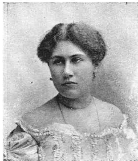
Obr. 309a. Autotypie obyčejnou mřížkou (na cm připadá 70 linek.)
