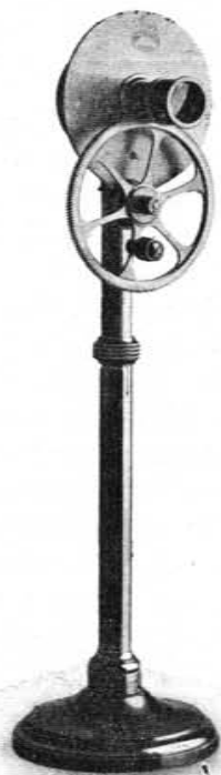
Obr. 430. Rotační přístroj ke studiu zákona Malusova.
